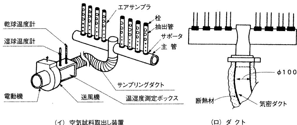
附屬書 図2 空気試料取出し装置とダクトの例
